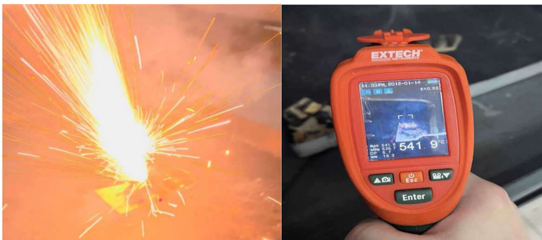
Рис.7. Образец № 2 после механического воздействия на аккумулятор
