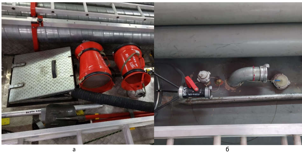
Рис.4. – Способы заправки водой головного автомобиля от АЦ по одному магистральному рукаву через устройства, не имеющие значительных гидравлических сопротивлений: а – при наличии крышки (люка), б – при наличии патрубка (сухотруба) с муфтовой пожарной соединительной головкой
