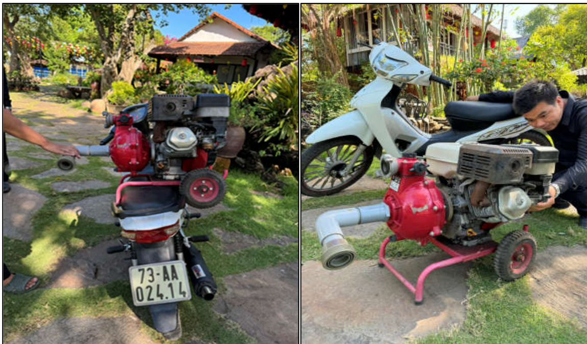
Рис.5. Транспортировка мотопомп пожарных с использованием приспособленной мотоциклетной техники
