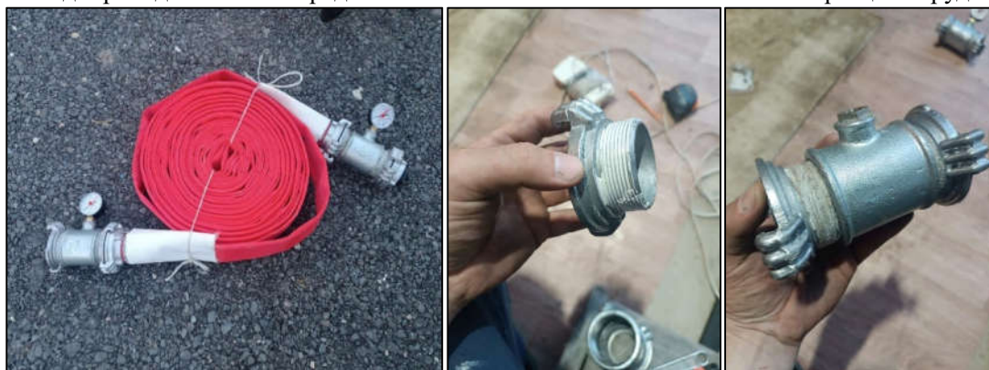
Рис.2. Основные этапы изготовления опытного образца гибкого перфорированного трубопровода с непрерывным расходом воды.
