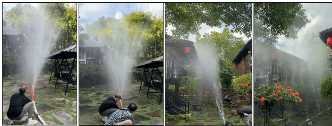
Рис.10. Эксперименты по прокладке магистральной линии для создания водяных завес на гибком и стационарном трубопроводах по наклонной поверхности.
