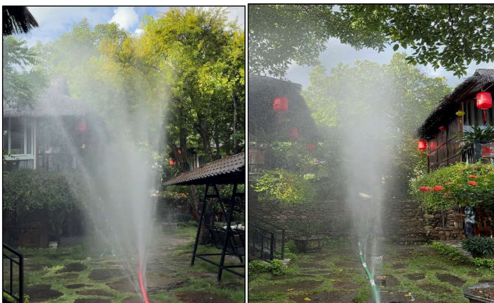
Рис.8. Водяные завесы из перфорированных трубопроводов, полученные при проведении экспериментов (гибкий трубопровод - слева, стационарный-справа)
