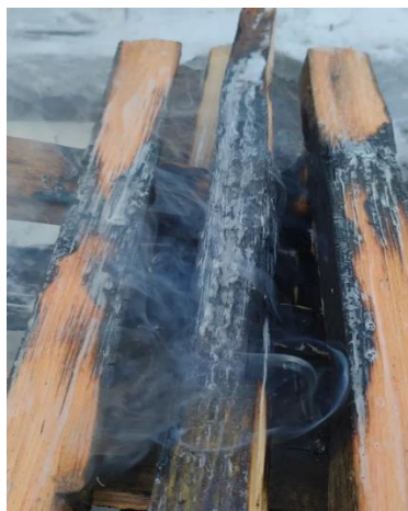
Рис.3. Плёнка на поверхности древесины, образованная в результате подачи водного раствора сульфанола
