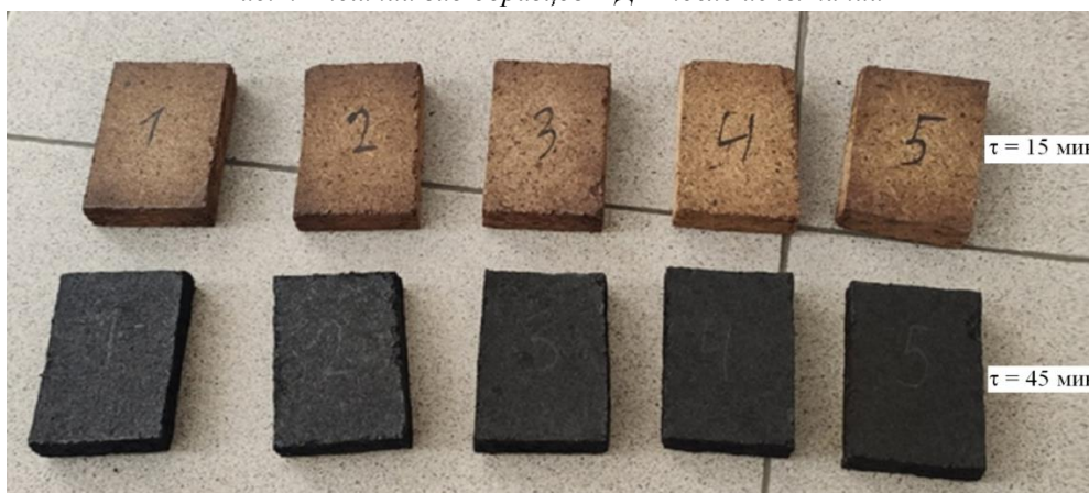
Рис.3. Внешний вид образцов ДСП после испытаний
