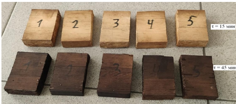
Рис.4. Внешний вид образцов доски из цельной древесины (сосны) после испытаний
