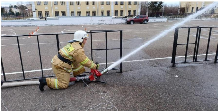
Рис.4. Фрагмент процесса проводимых экспериментальных исследований зависимости расхода ЛС-П20У от напора (фото авторов)
