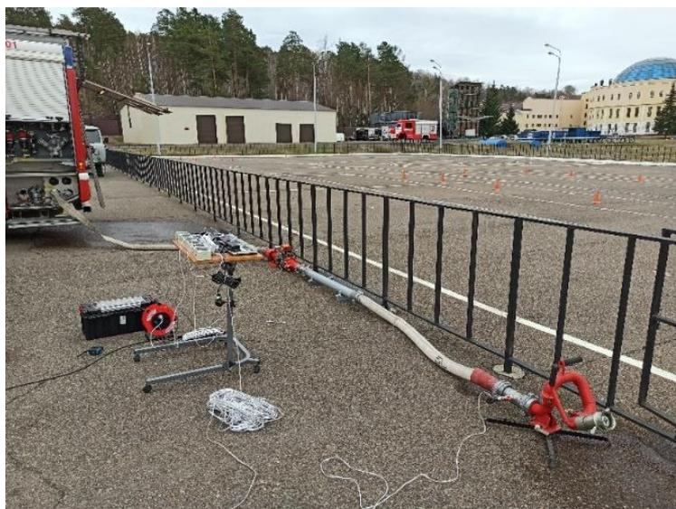
Рис.2. Общий вид реализованной схемы, используемой для получения расходов ЛС-П20У в условиях переменных значений напора (фото авторов)
