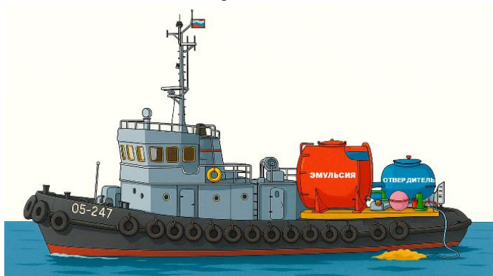
Рис.3. Автономная пеногенерирующая газожидкостная установка размещенная на плавсредствах
