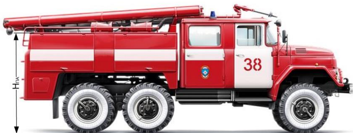
Рис.3. Методика и схема, использованная авторами для замера геометрической высоты пожарного автомобиля H_{ПА}
