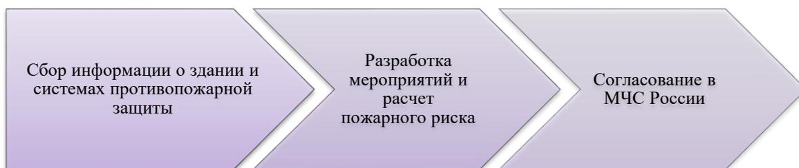
Рис.3. Этапы разработки комплекса инженерно-технических мероприятий по пожарной безопасности
