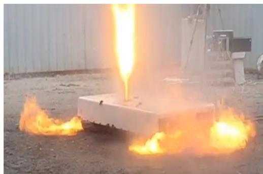
*Рис.4. Моделирование воздействия перезаряда на литий-ионные аккумуляторы до состояния теплового разгона*
