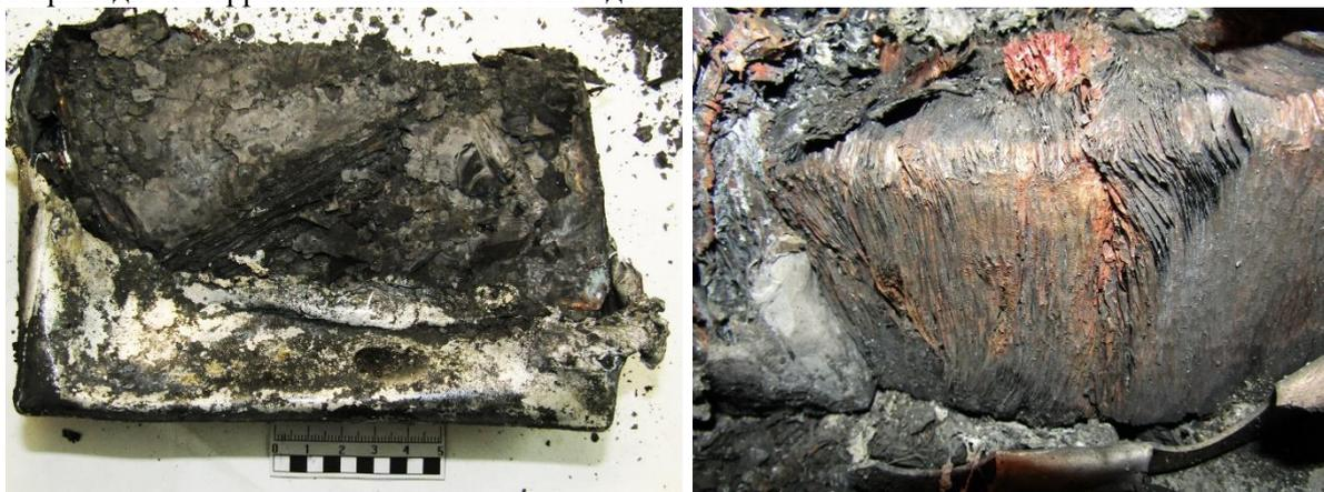
Рис.5. Внешний вид литий-ионного аккумулятора, после теплового разгона вызванного перезарядом
